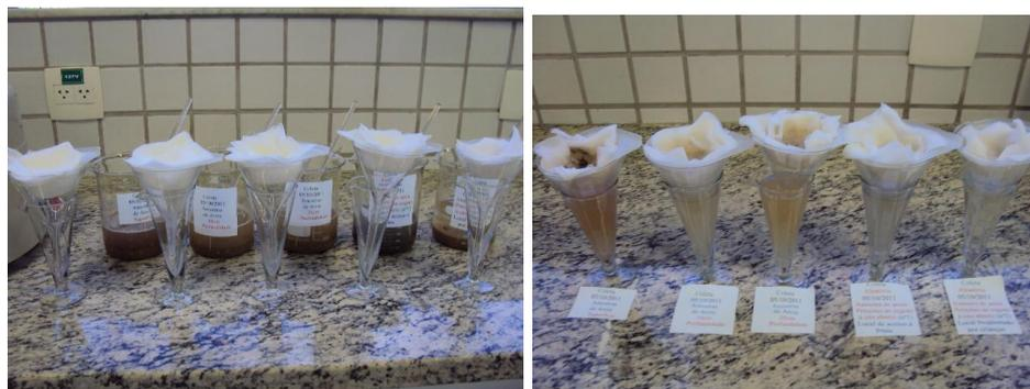
Ilustração 28: Amostras de areia em processo de filtração.
