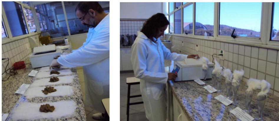
Ilustração 27: Amostras de areia em gazes, posterior ao processo de sedimentação (esquerda). Regulação ao banho-maria a 45 °Celsius para sedimentação (direita).
