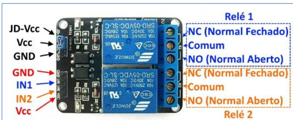
Imagem 8: Pinagem do módulo do relé 2 canais.
