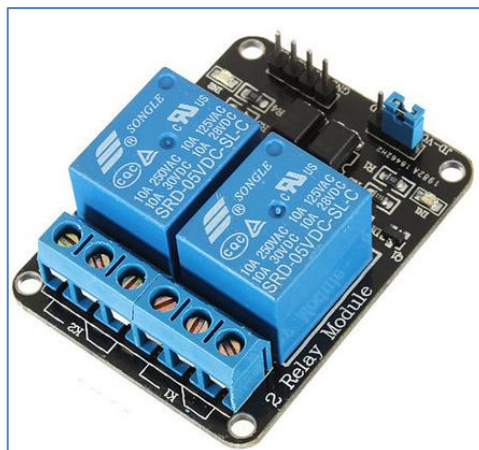
Imagem 7: Módulo do relé 5v 2 canais.
