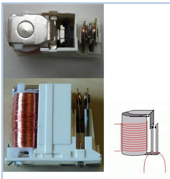
Imagem 5: Estrutura interna de um relé.
