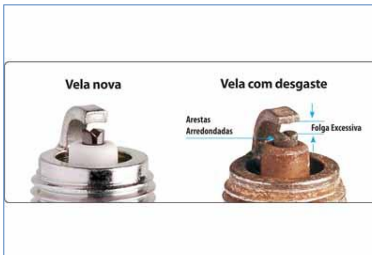
Imagem 12: Vela de ignição nova versus vela de ignição com desgaste.
