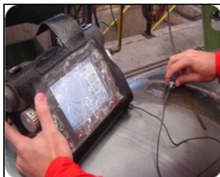
Figura 12 - Inspeção por Ultrassom Manual
