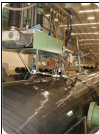
Figura 10 - Inspeção por Ultrassom Online
