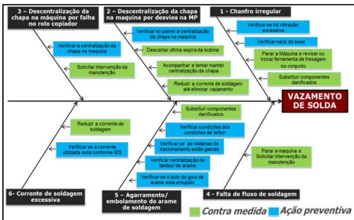
Figura 22 - Ishikawa: Vazamento de Solda
