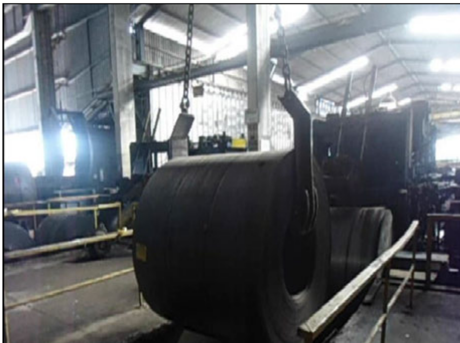
Figura 2 - Posicionamento da bobina na entrada da LCT 03
