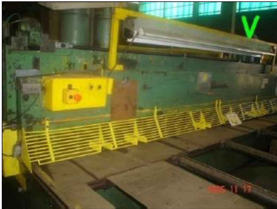
Figura 22 - Modelo de proteção frontal para guilhotina
