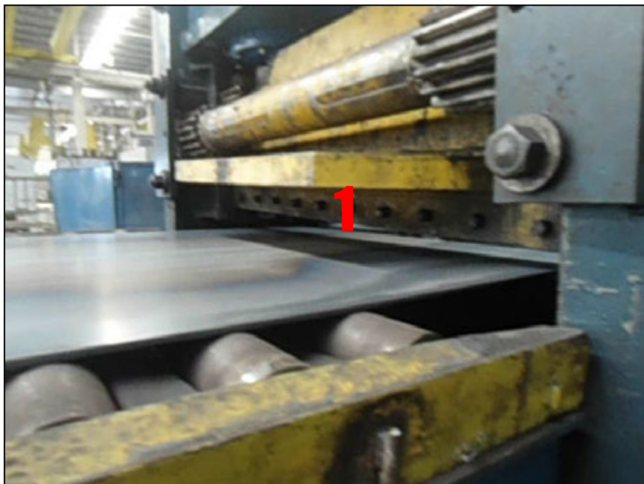
Figura 21 - Guilhotina da laminadora sem proteção
