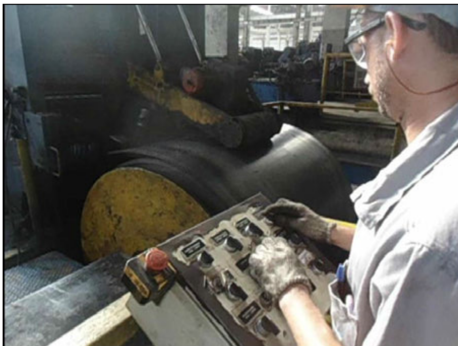
Figura 3 - Painel de controle para ajustar a bobina na entrada da LCT 03
