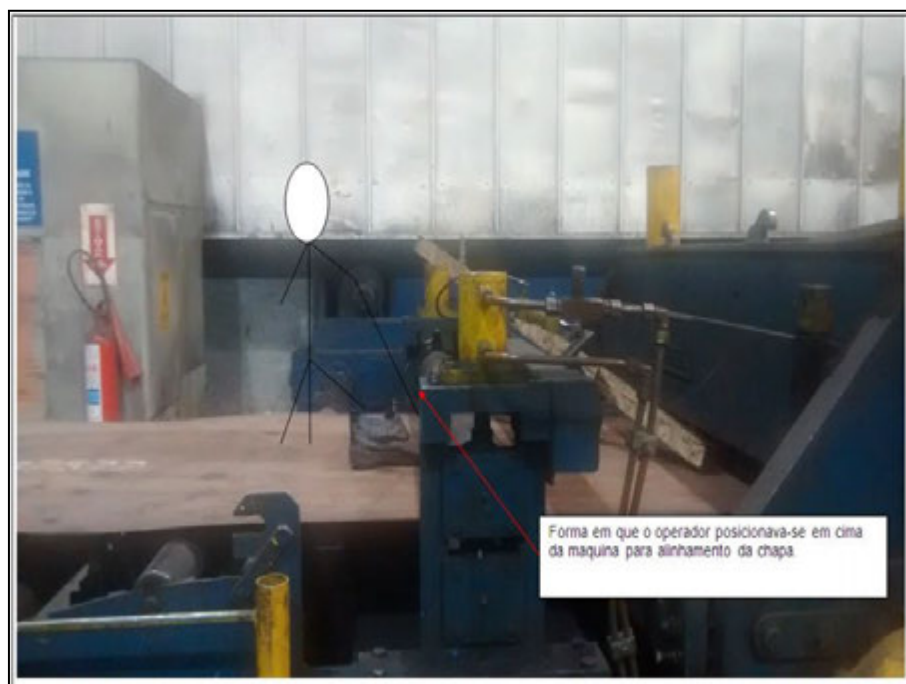
Figura 5 - Posicionamento do pé do auxiliar no momento do acidente
