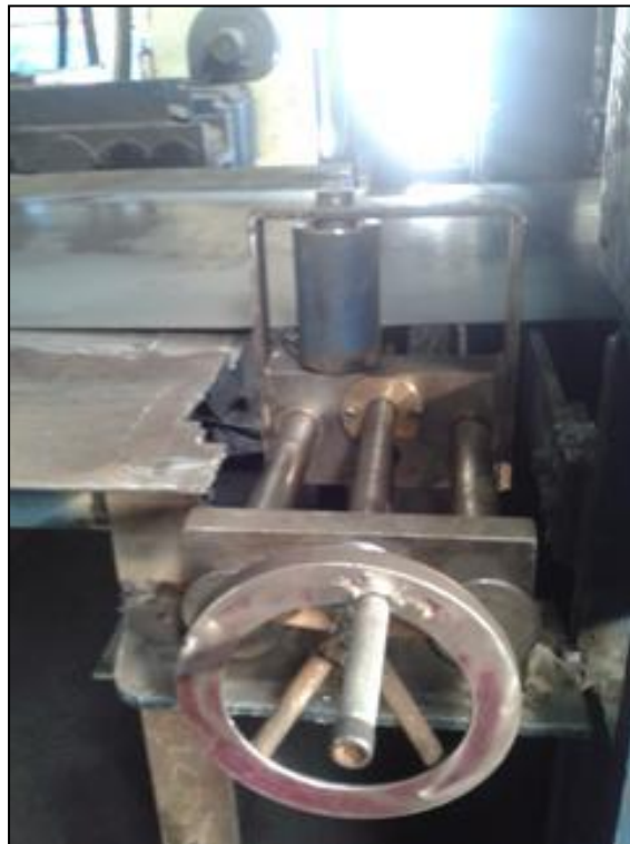
Figura 6 - Equipamento adaptado para alinhar a chapa na laminadora
