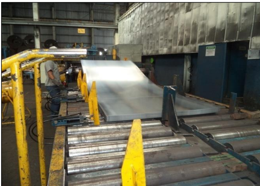
Figura 7 - Adaptação de dispositivos auxiliares de empilhamento de chapa
