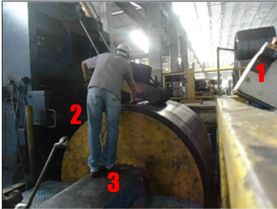
Figura 17 - Risco no ajuste da bobina ao cortar a presilha
