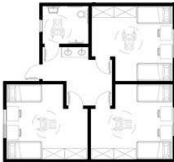
Figura 23 - Planta baixa edificação hospedagem acessível
