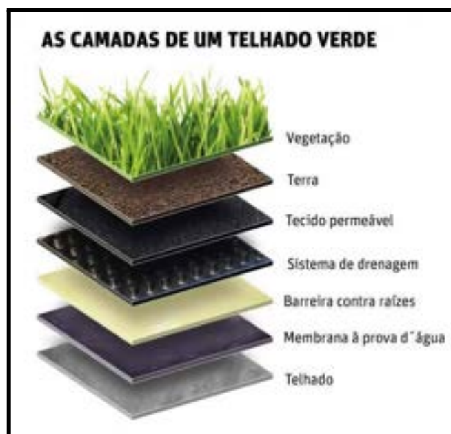
Figura 37: Camadas Telhado verde
