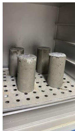
Imagem 14 (v) Corpos-de-prova submerso (w) Corpos-de-prova na estufa
