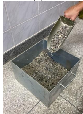
Imagem 5 (g) Pesagem da amostra (h) Massa unitária solta
