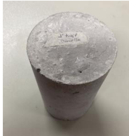
Imagem 15 (x) Vazios presentes no 4 traço (y) Superfície traço 1
