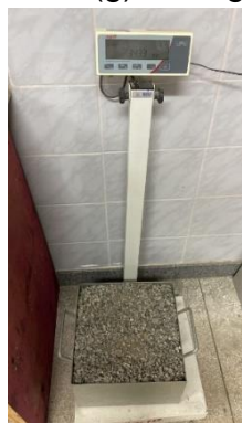
Imagem 5 (g) Pesagem da amostra (h) Massa unitária solta
