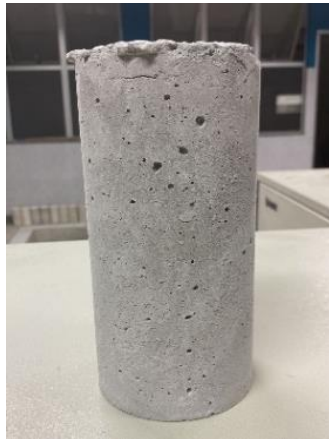
Imagem 15 (x) Vazios presentes no 4 traço (y) Superfície traço 1
