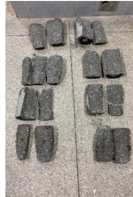
Imagem 13 (t) Ensaio de compressão (u) Corpos de prova rompidos
