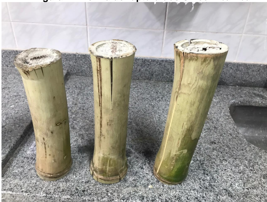
Figura 4 – Forma de ruptura dos CP com bambu
