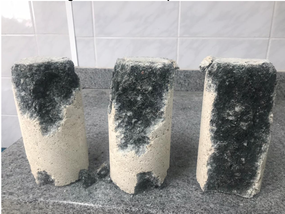
Figura 3 – Forma de ruptura dos CP
