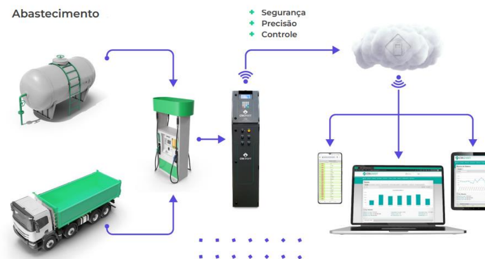
Figura 3 – Desenho esquemático do sistema de automação da bomba de combustível do tanque interno
