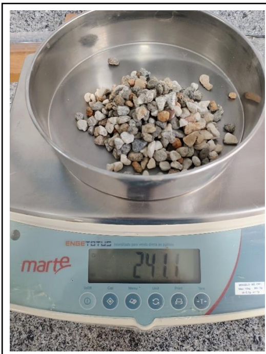
Figura 26: Massa retida 6,3mm – 2ª amostra
