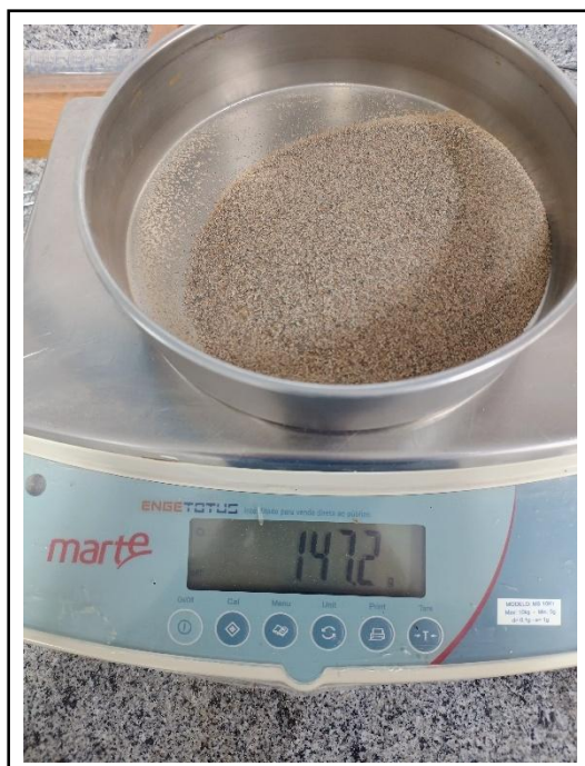
Figura 31: Massa retida 300 \mu\text{m} – 2ª amostra
