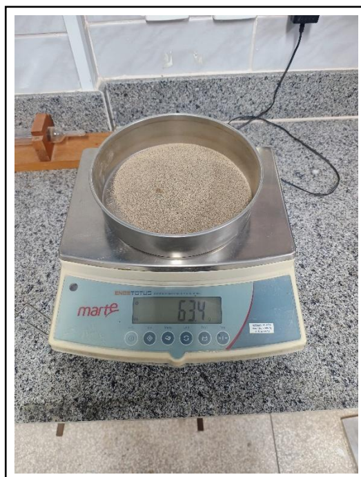
Figura 20: Massa retida 300 \mu\text{m} – 1ª amostra
