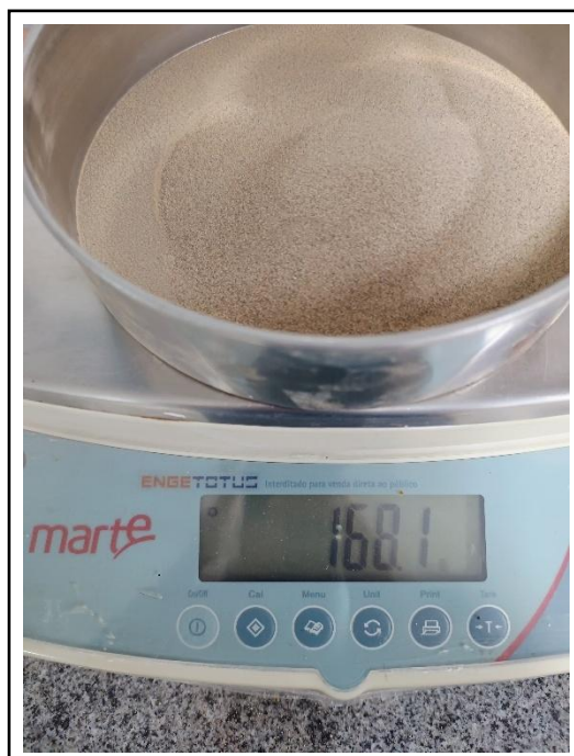
Figura 32: Massa retida 150 \mu\text{m} – 2ª amostra
