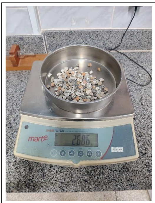
Figura 15: Massa retida 6,3mm – 1ª amostra
