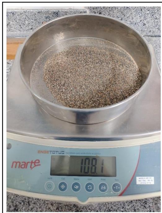
Figura 30: Massa retida 600 µm – 2ª amostra
