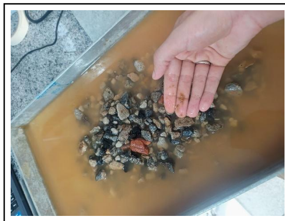
Figura 40: Dissolução das argilas e friáveis
