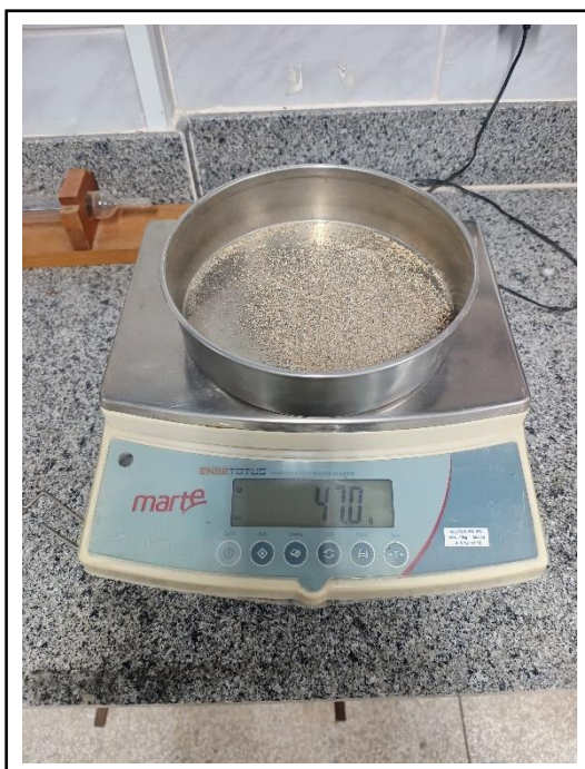
Figura 19: Massa retida 600 \mu\text{m} – 1ª amostra
