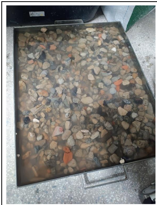
Figura 34: Amostra submersa em água por 24h
