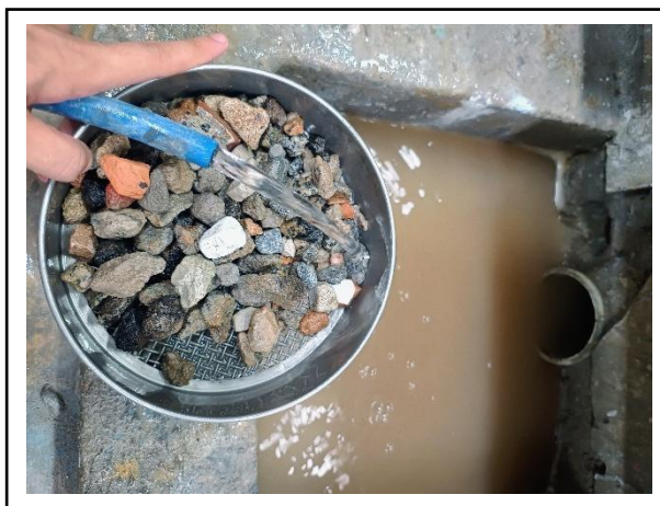
Figura 4: Lavagem do material na peneira 4,75mm
