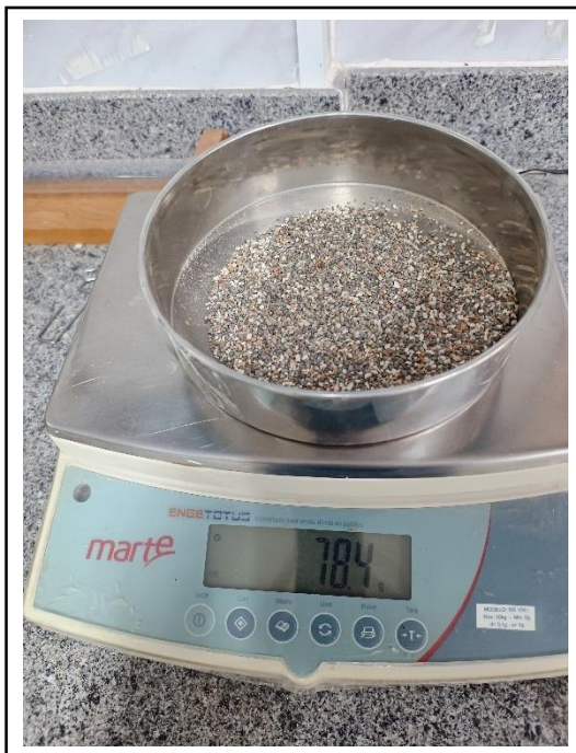
Figura 29: Massa retida 1,18mm – 2ª amostra
