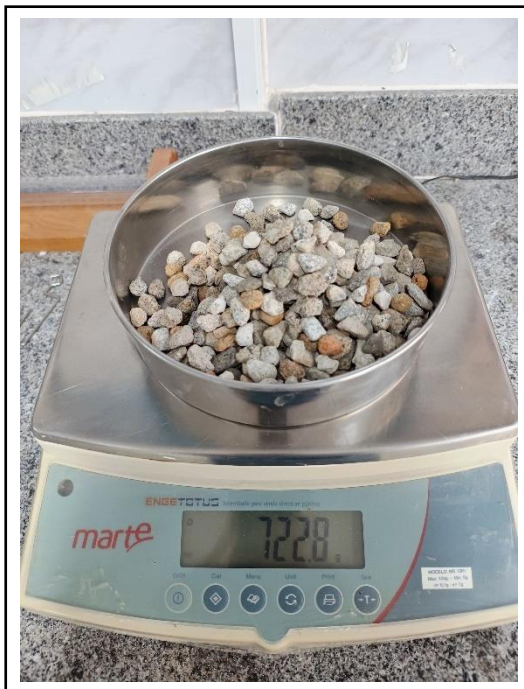
Figura 25: Massa retida 9,5mm – 2ª amostra
