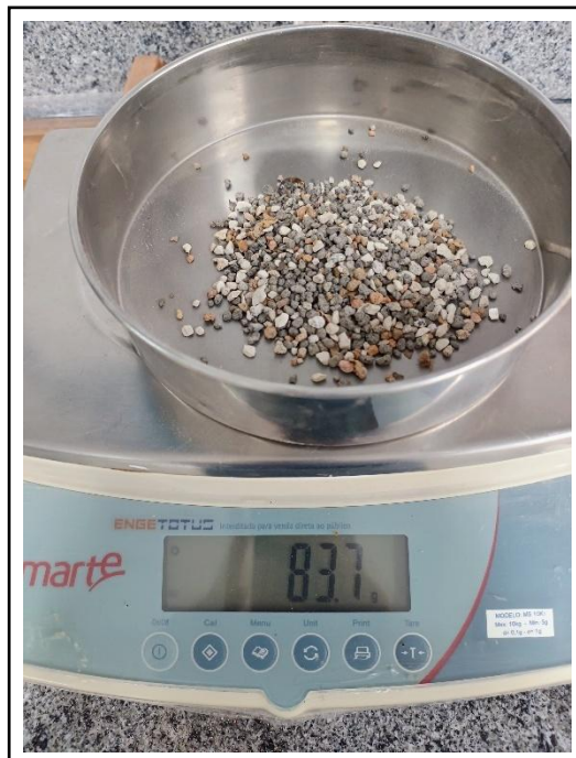
Figura 28: Massa retida 2,36mm – 2ª amostra
