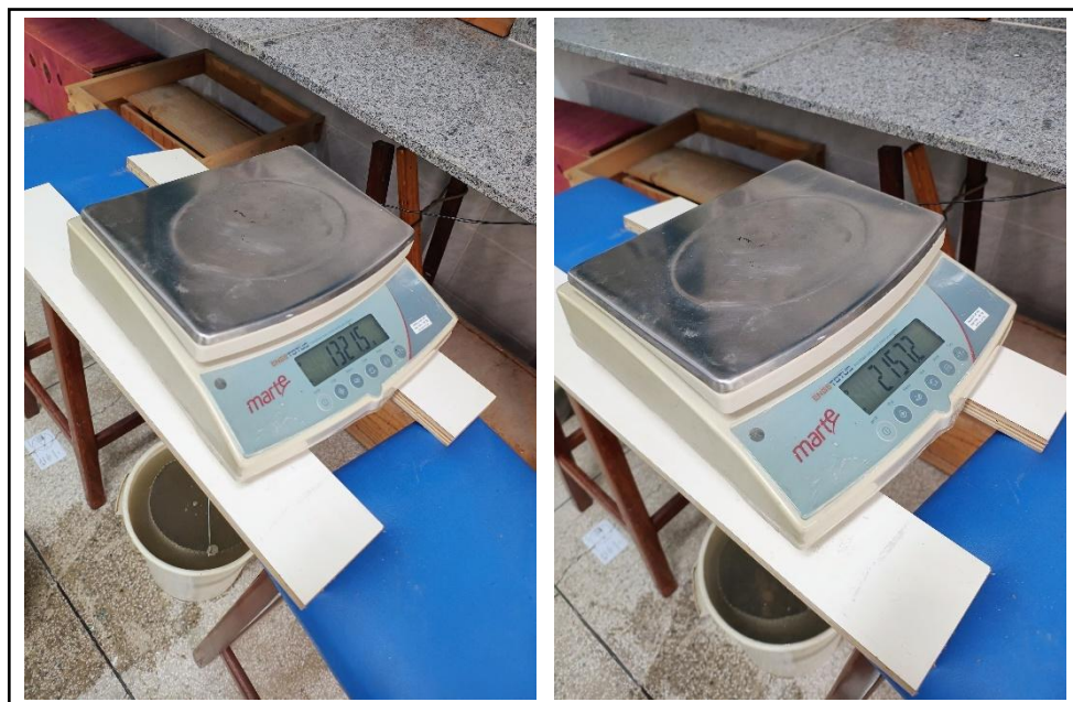
Figura 5: Pesagem da amostra submersa em água
