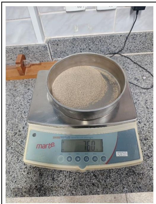
Figura 21: Massa retida 150 \mu\text{m} – 1ª amostra
