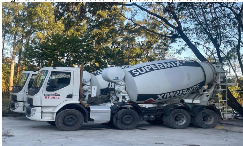
Figura 5: Caminhão betoneira para transporte até a obra.
