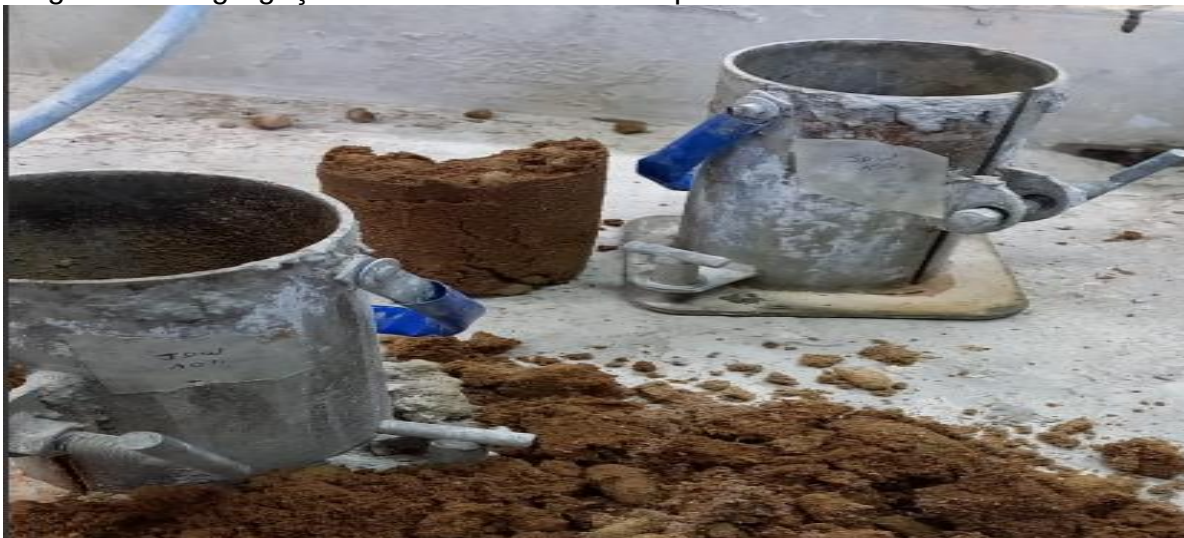
Imagem 2 – Segregação da mistura de 50% do pó de madeira
