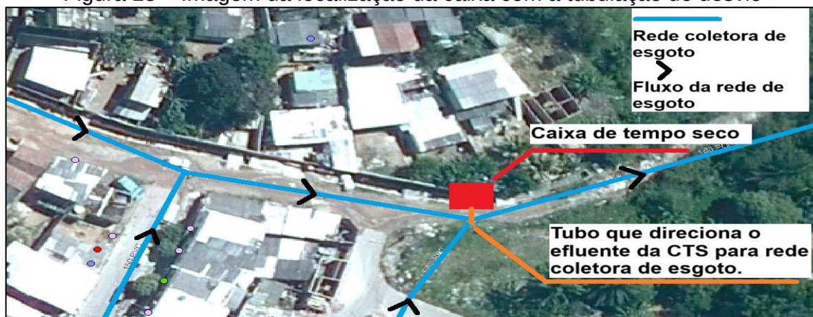
Figura 13 – Imagem da localização da caixa com a tubulação de desvio
