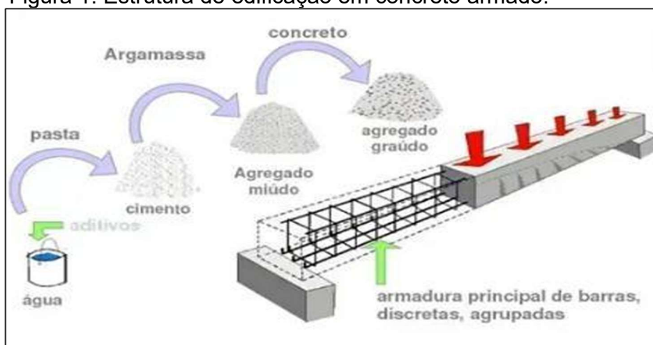
Figura 1: Estrutura de edificação em concreto armado.
