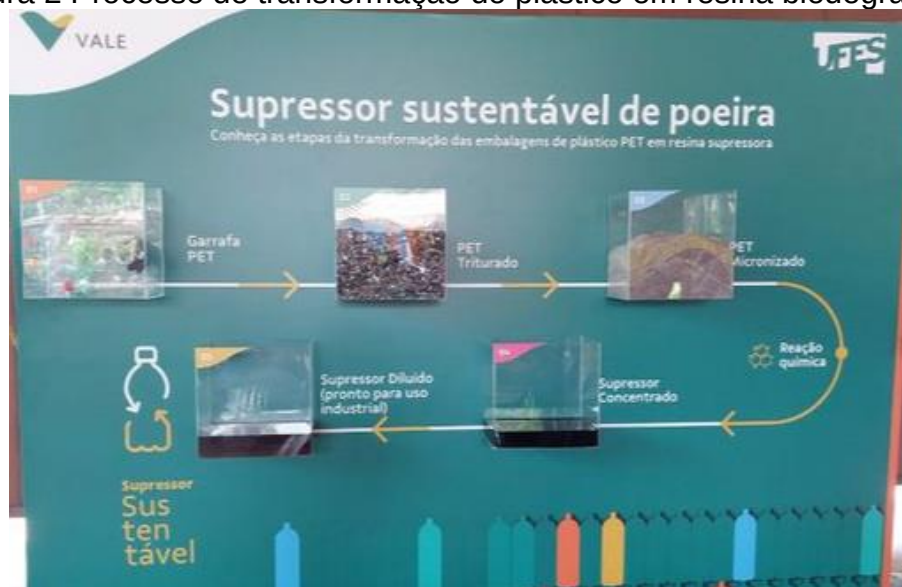
Figura 2 Processo de transformação do plástico em resina biodegradável
