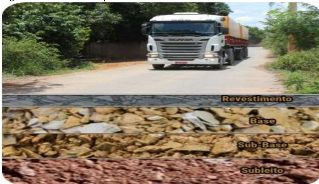
Figura 1 – Camadas do pavimento flexível
