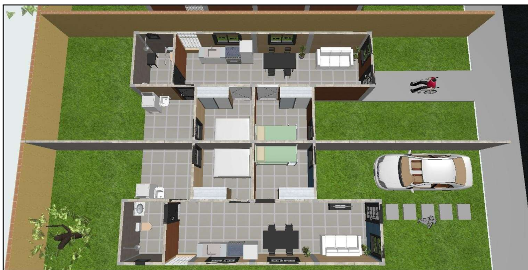
Figura 11 - Planta baixa humanizada com duas unidades habitacionais, sendo uma adaptada para acessibilidade
